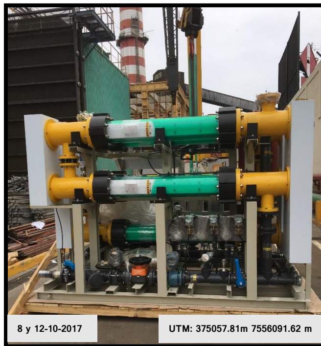
Figura 5: Desembalaje de la celda de electrolisis.
