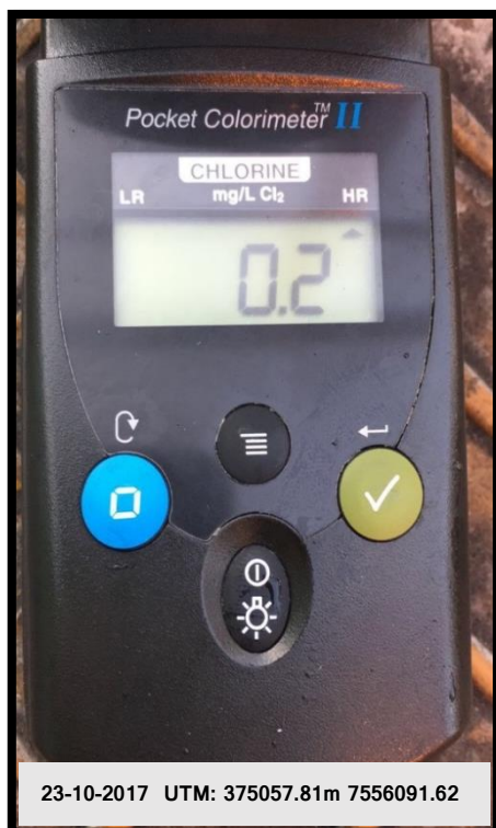
Figura 20: Medición de cloro libre residual con colorímetro portátil en la descarga del filtro Debris.
